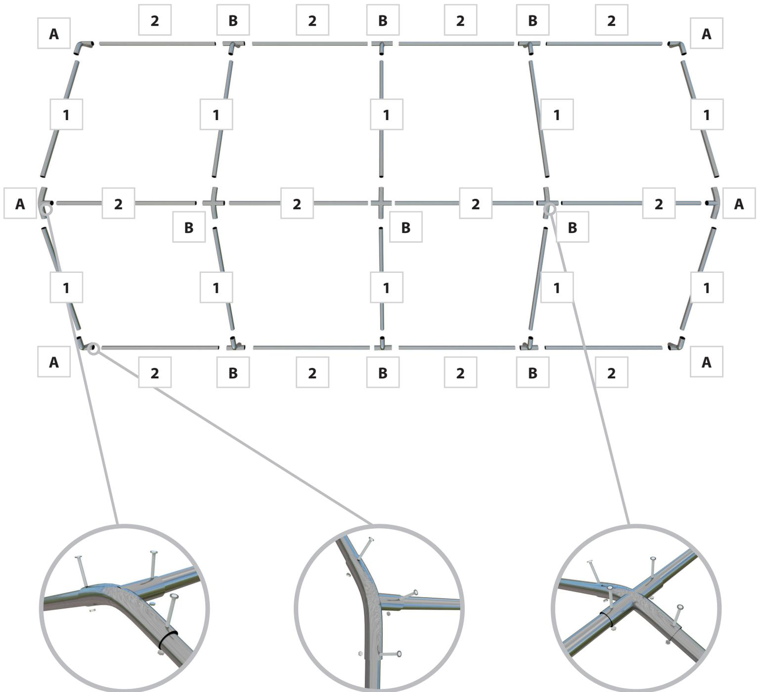
Die nächsten Rohre (1), (2) werden mit den entsprechenden Verbindern (A) und (B) unter Verwendung von Mx50-Schrauben (10) verbunden.
