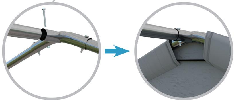
Legen Sie die Dachplane **(5)** so auf die entfaltete Struktur, **dass die Hülsen zum Spannen der Plane von innen zwischen den Beinen der Struktur liegen.**
